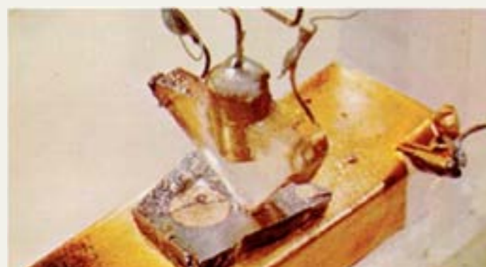
Рис. 4. Первый транзистор на поликристаллическом германии
