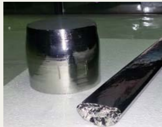
Рис. 2. Слитки монокристаллического (слева) и поликристаллического (справа) германия
