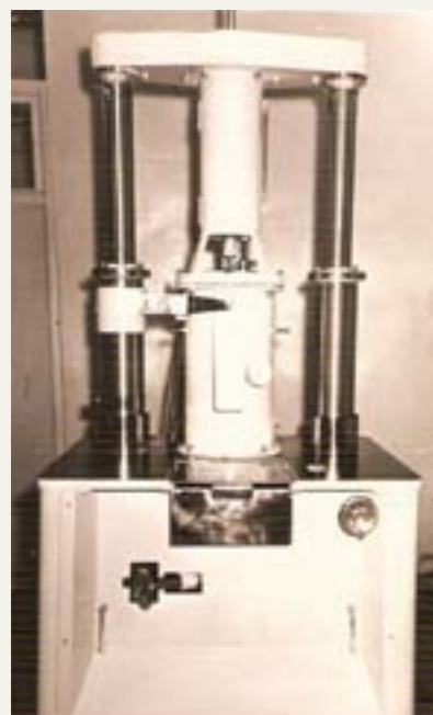
Рис. 8. Одна из первых промышленных установок выращивания кристаллов методом Чохральского
